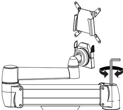
Monitorarm parallel zur Tischplatte positionieren.
