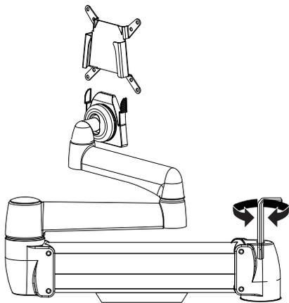
Monitorarm parallel zur Tischplatte positionieren.
