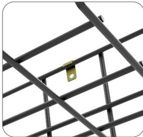
Der Cable Basket Kabelkorb ist eine stabile Schweißkonstruktion aus Stahldraht mit strapazierfähiger Pulverbeschichtung für höchste Haltbarkeit. Die Pulverbeschichtung verhindert scharfe Kanten und beugt Korrosion vor. Eine unlackierte Messing-Erdungslasche sorgt für maximale elektrische Sicherheit.
