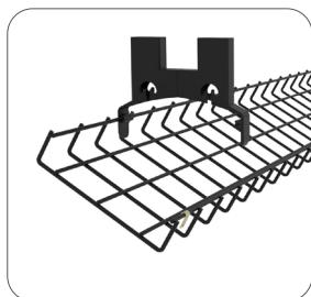
Die Anbringung des Korbs erfolgt schnell und unkompliziert durch Einhängen in am Träger befindliche Haken. Dadurch kann bei Arbeiten an der Verkabelung eine Seite des Korbs ausgeklinkt und somit der Zugang zu Steckdosen, Netzadapter und Strom-/Datenkabeln ermöglicht werden.
