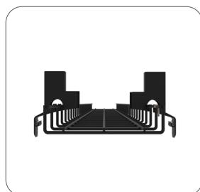
Für Cable Basket-Kabelkörbe gibt es ein flexibles Befestigungs-Set aus je zwei Kunststoff-Trägern, die an geeigneten Stellen unter der Tischplatte befestigt werden. Die Träger sind teilbar, um ggf. unter der Platte vorhandene Konstruktionen zu überbrücken oder den Kabelkorb etwas näher zur Tischplatte aufhängen zu können (zweite Höhen-Position).
